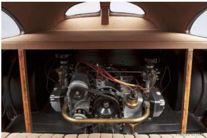
Obrázok 18 Motor plochý boxer uložený v „dreve“. Interier.
